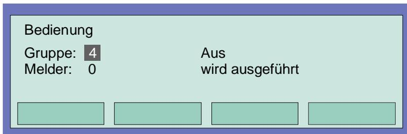
Zusätzlich zur Klartextmeldung im Display wird die Abschaltung mit der Sammelanzeige >Abschaltung< auf dem Bedienfeld und der entsprechenden, dauerleuchtenden gelben LED der Gruppeneinzelanzeige (falls vorhanden) optisch angezeigt.
