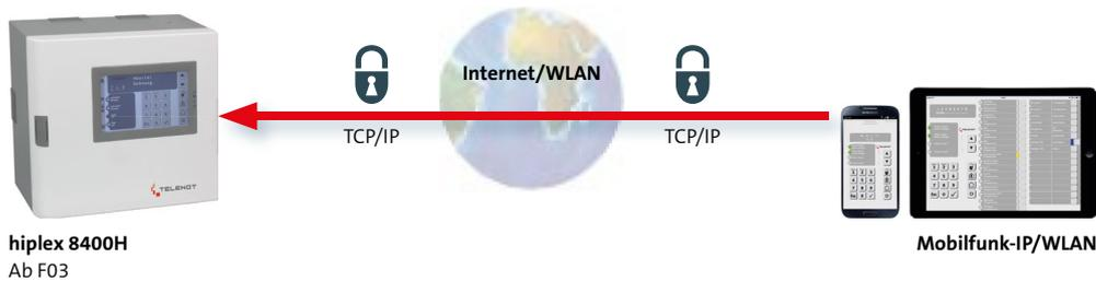
**!** Diese Verbindungsart von BuildSec 4.0 ist nicht zum Einsatz an einem IPv6-Anschluss mit DualStackLite (DSLite) geeignet.
